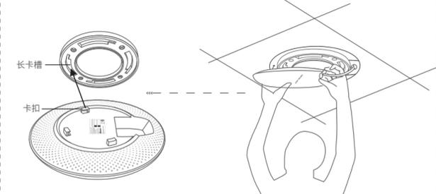
7. 将AP嵌入到安装架上, 再顺时针方向旋转固定AP, 完成安装
