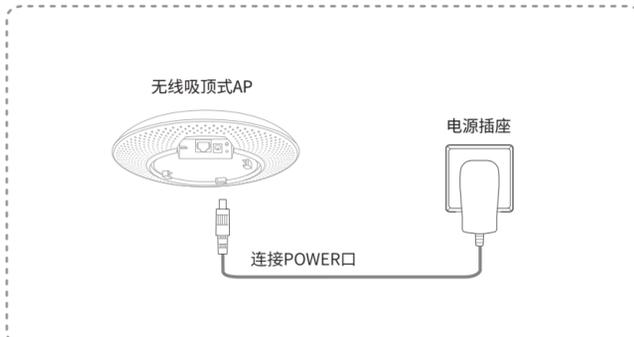
◆接通电源后，AP将自动进行初始化，此时系统指示灯先是常亮，初始化完成后，会闪烁2秒，待系统指示灯再次常亮，表示设备已正常工作。指示灯含义说明请参考产品介绍中的系统指示灯含义列表。
