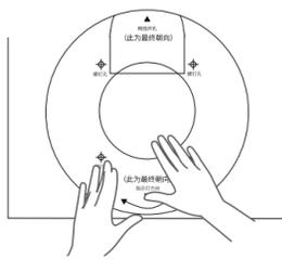
2. 按定位贴上标记的位置, 用冲击钻在墙面上钻出4个直径为6mm的钻孔
