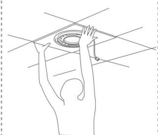
6. 先用网线连接AP, 再对齐安装架和AP, 注意卡口对准长卡槽
